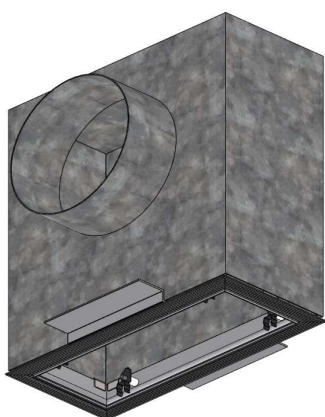
3 - Portare in battuta il plenum sulle baionette di ancoraggio
