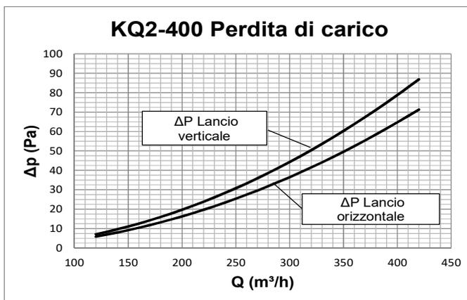
Dati ricavati da modellazione matematica CFD in camera di prova virtuale operando in accordo con la norma internazionale:
