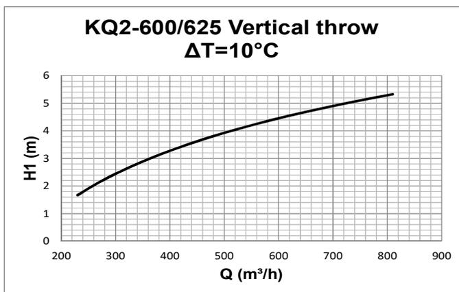
Dati ricavati da modellazione matematica CFD in camera di prova virtuale operando in condizioni di riscaldamento con  $\Delta T=10^\circ\text{C}$  in accordo con la norma internazionale:
