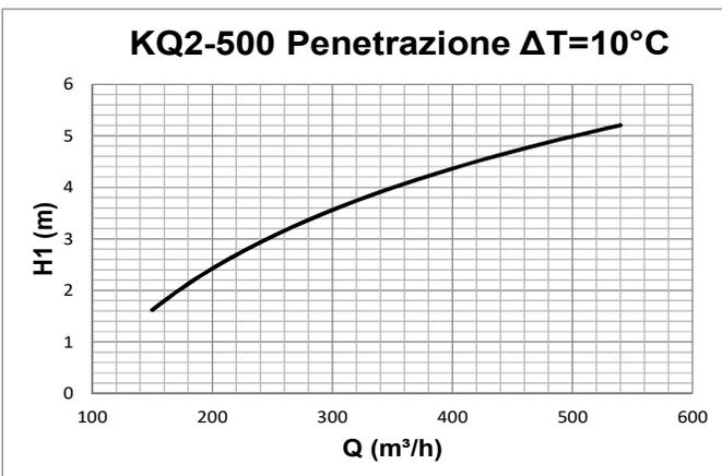
Dati ricavati da modellazione matematica CFD in camera di prova virtuale operando in condizioni di riscaldamento con  $\Delta T=10^{\circ}\text{C}$  in accordo con la norma internazionale:
