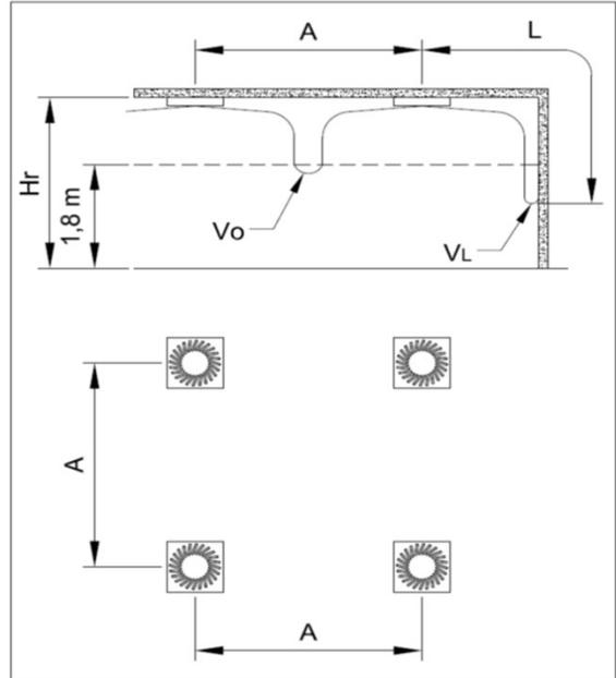
Dati ricavati da modellazione matematica CFD in camera di prova virtuale operando in condizioni isoterme in accordo con la norma internazionale: **ISO 5219 1984: Air distribution and air diffusion - Laboratory. Aerodynamic testing and rating of air terminal devices.**
