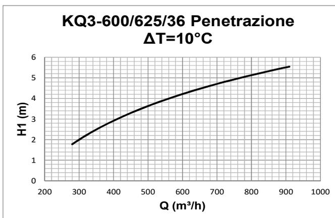
Dati misurati operando in condizioni di riscaldamento con  $\Delta T=10^{\circ}\text{C}$  in accordo con la norma internazionale:
