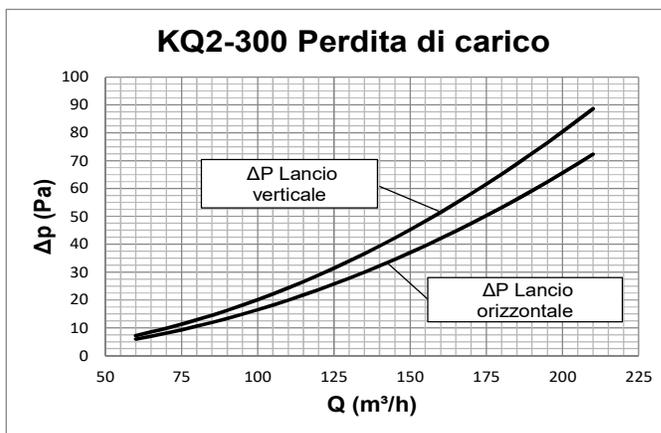
Dati ricavati da modellazione matematica CFD in camera di prova virtuale operando in accordo con la norma internazionale:
