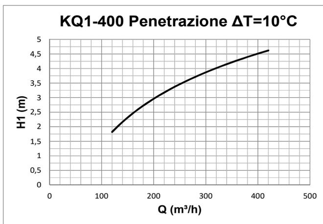
Dati ricavati da modellazione matematica CFD in camera di prova virtuale operando in condizioni di riscaldamento con  $\Delta T=10^\circ\text{C}$  in accordo con la norma internazionale:
