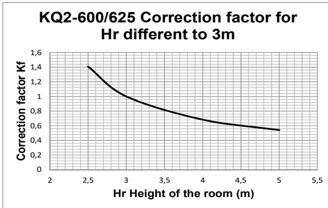
Dati ricavati da modellazione matematica CFD in camera di prova virtuale operando in condizioni isotermitiche in accordo con la norma internazionale: ISO 5219 1984: Air distribution and air diffusion - Laboratory. Aerodynamic testing and rating of air terminal devices.
