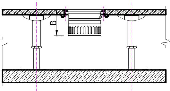
TE-KP montaggio su pavimento galleggiante con plenum
