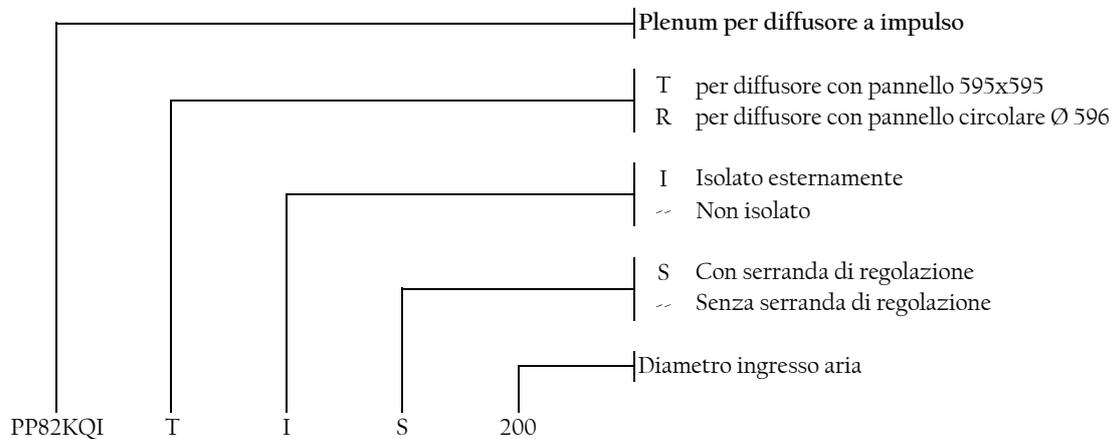
per il corretto funzionamento, il diametro di ingresso aria del plenum deve essere uguale al diametro nominale del diffusore
